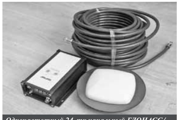
Одночастотный 24-ти канальный ГЛОНАСС/ GPS приемник МНП-М7 производства Ижевского радиозавода
