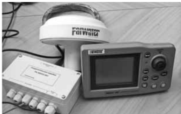
Судовой приемоиндикатор ГНСС ГЛОНАСС/GPS со встроенным приемником дифференциальной поправки РК-2006мк2 («Радио Комплекс»)
