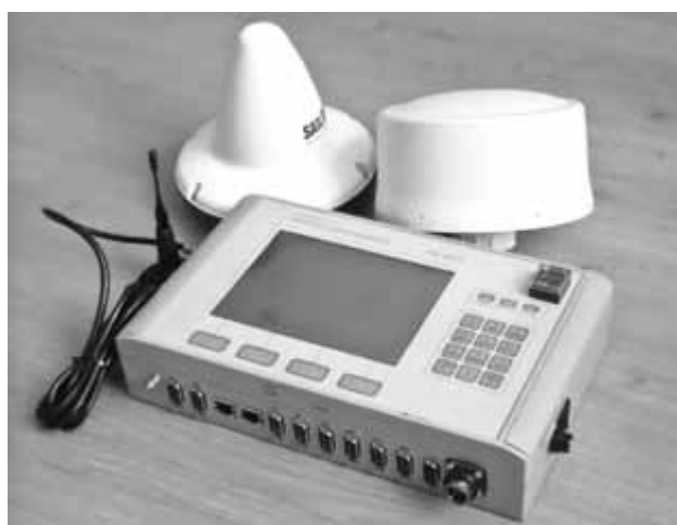
Навигационная аппаратура со встроенным приемником дифференциальных поправок и функциями управления внешними комплексами и системами связи для целей мониторинга и информационно-навигационного обеспечения речных и морских судов СН-5703 («КБ НАВИС»); СН-5703
