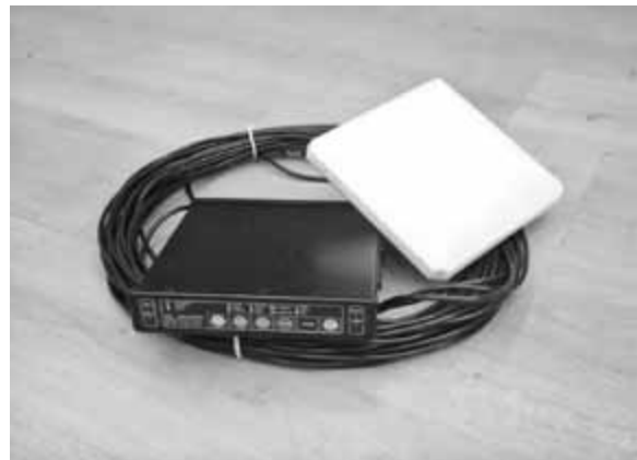
16-ти канальный ГЛОНАСС/GPS приемник «Аква-борт-12», предназначенный для использования в морском и речном судоходстве («РИРВ»)
