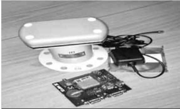
Персональный навигатор ГЛОНАСС/GPS НТ-1813 («РИРВ»)
