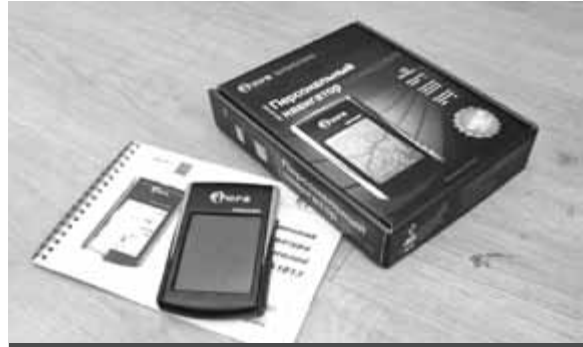
Аварийно-спасательный радиомаяк ПАРМ-406А («НИИ КП»)
